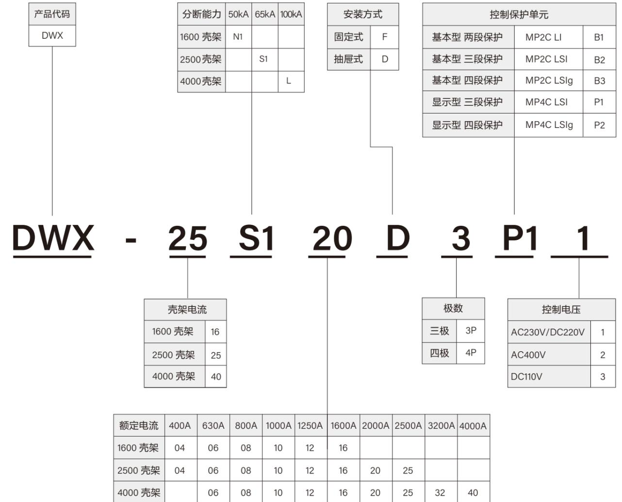
标准配置: 固定式: 本体、控制器、分励脱扣器、合闸线圈、电动操作机构、4NC/4NO辅助触头、水平后接线端子、密封门框、相间隔板、电源模块。
