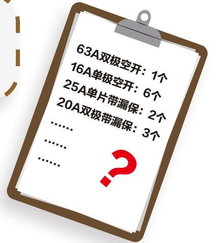
**空开：**一般指小型断路器，当电线过载或短路时，断路器会自动断开，具有过载和短路保护功能。
