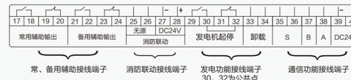
注: ① 通讯模块在系统正常工作时无需外部电源, 只有当系统断电时, 如果需要持续通讯, 需要外接DC24V电源。
