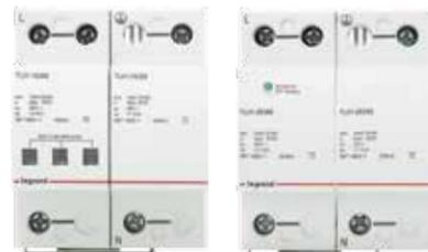
TLU1 系列电涌保护器用于电源系统的浪涌保护，用于交流额定电压 220V/380V，频率 50/60Hz 的电路和设备，对瞬时过电压的电涌进行防护，将浪涌大电流泄放到大地，对过电压进行限制，从而保护线路和设备以及人身的安全。
